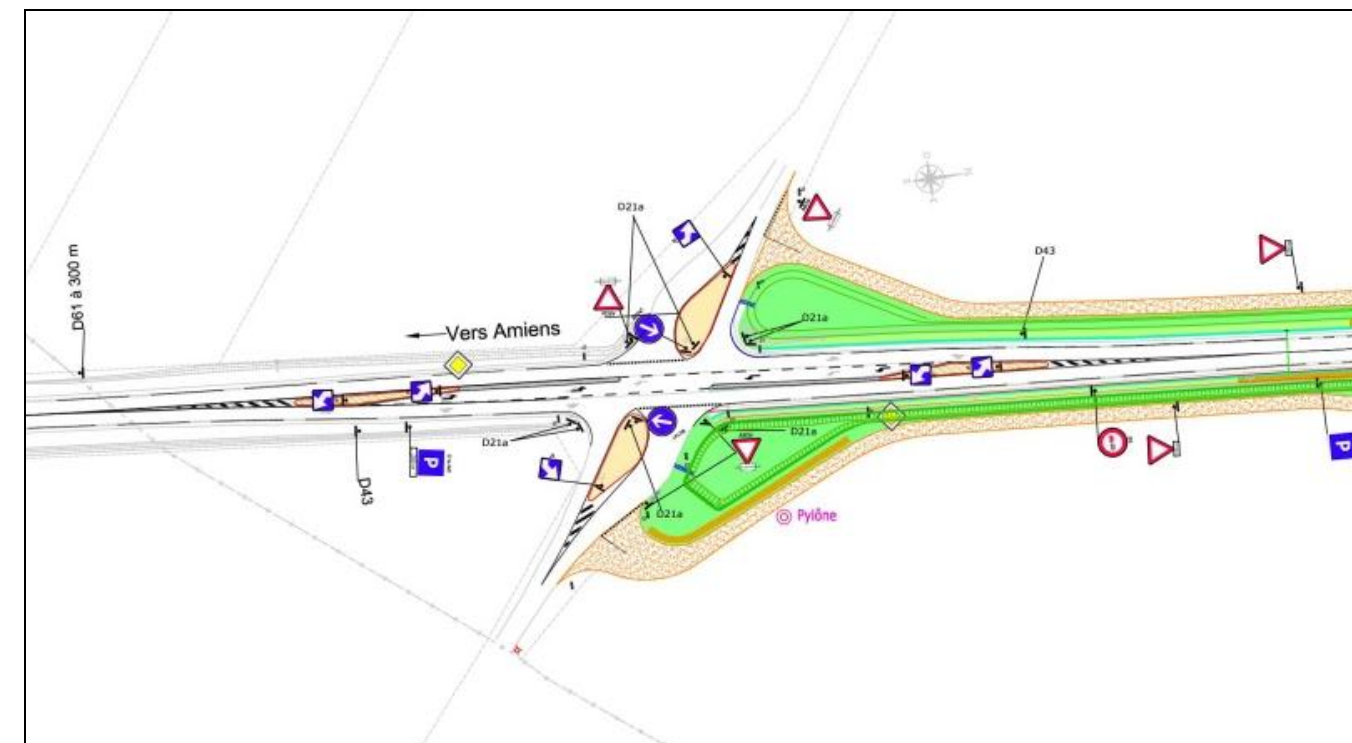
Principe d'aménagement du carrefour de la RN25 et de la RD31- VERDI
